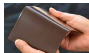
無機ハイブリッドコートJYを塗布した鉄板を曲げている様子。
